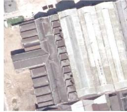
Figure 25. Exemple de shed (FID 51; Perron ouest - Seraing)
